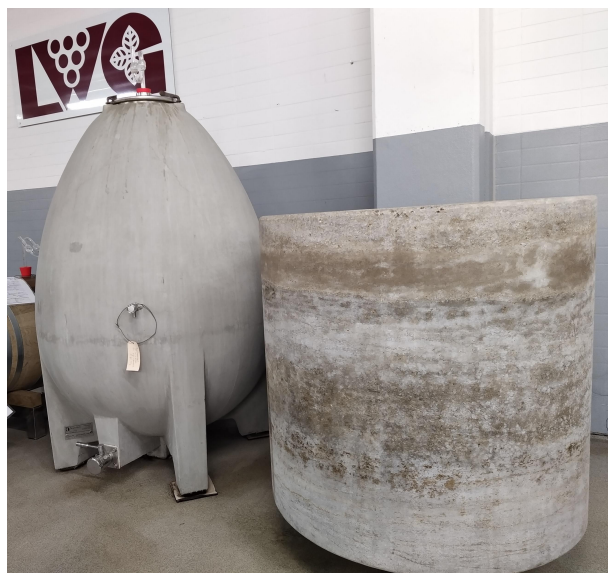
Bild 3: Betoneier neben Muschelkalkfass.
