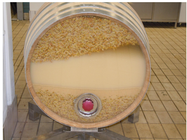
Bild 2: Drehbares Holzfass für die Maischegärung
