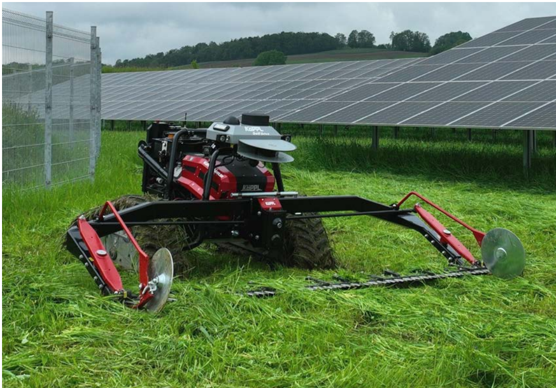
Hier wird die Navigation im Freiflächenphotovoltaikpark mit dem Autonomiekit Köppl SelfDrive® getestet.
