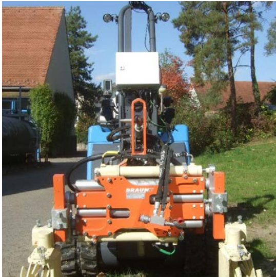
Raupenfahrzeug ausgestattet mit Lasersensoren zur effektiven Steillagenbewirtschaftung.
