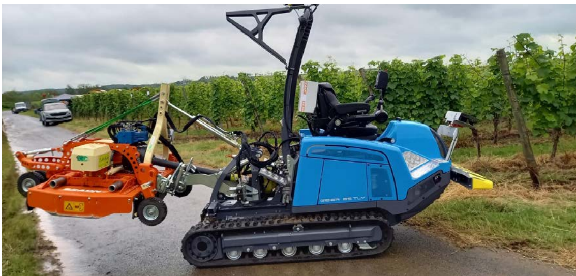
Digitale Technik zur effizienten Steuerung der mechanischen Beikrautregulierung unter den Rebstöcken. Quelle: LWG
