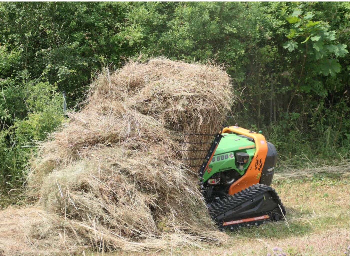
Mithilfe eines Pickupschwaders lässt sich Mähgut auch aus steilen Böschungen abräumen.
