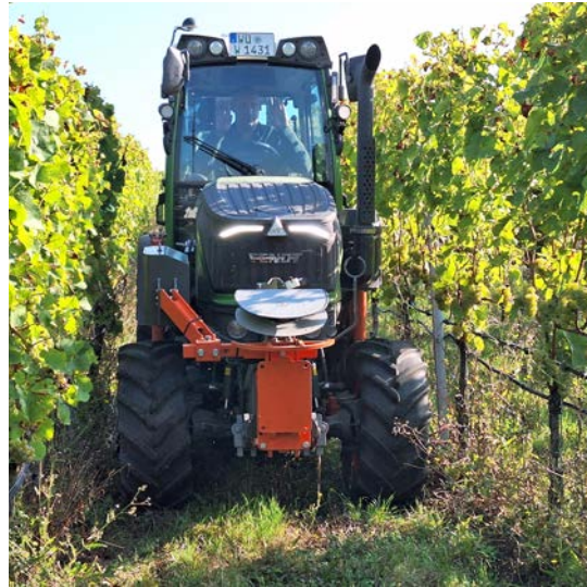
Hands up! Digitale Technik zur effizienten Steuerung der mechanischen Beikrautregulierung unter den Rebstöcken.
