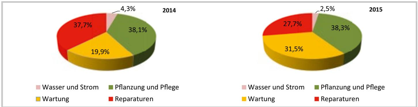
Abbildung 4: Anteilige jährliche Aufwendungen für Betrieb und Unterhalt von geprüften Vertikalbegrünungssystemen im ersten und zweiten Versuchsjahr (Mittelwerte über alle Systeme)
