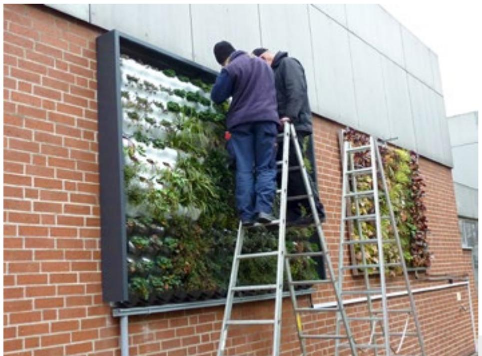
Bild 1: Letzter Check vor Versuchsbeginn – Mitarbeiter der LWG justieren die Temperaturfühler an den Systemen „Humko“ und „Vertiko“ im November 2013
