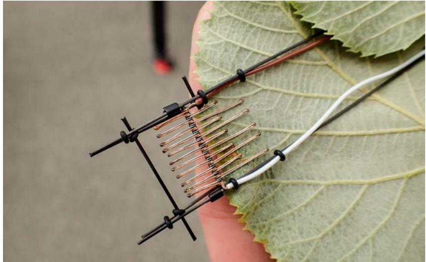
Bild 3: Blatt-Temperaturmesssonde.
