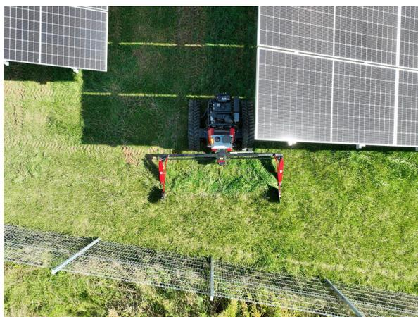
Bild 7: Kopppl Crawler mit Autonomiekit (inklusive Laserscanner) bei der autonomen Navigation zwischen den Modulreihen.
