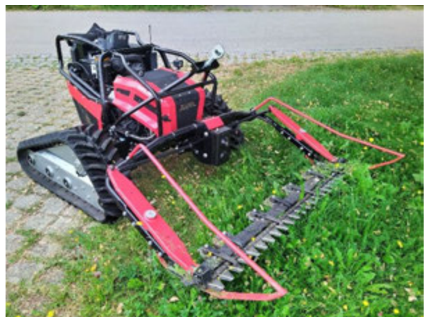
Bild 3: Ferngesteuerter und autonom steuerbarer Raupen-Geräteträger mit höhenverstellbarem Mähbalken-Anbau bei einer der beiden Maschinen-vorführungen zum Thema „Mahd im öffentlichen Grün – effektiv und biodiversitätsschonend“ 2021.
