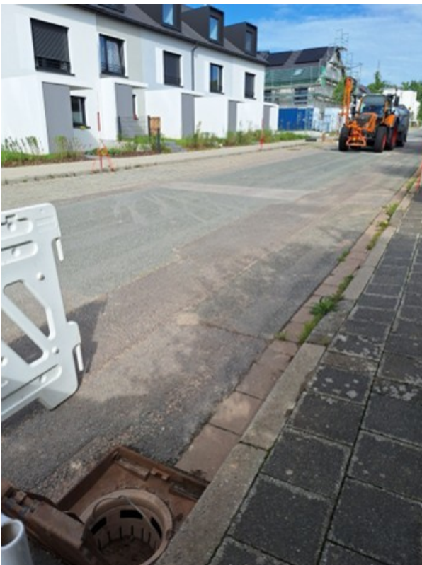
Bild 1: Zur Gewinnung der Wasserproben wurde ein fünfjähriges Regenereignis durch die Firma Arauner auf 100 m 2 der Wohnstraße simuliert.
