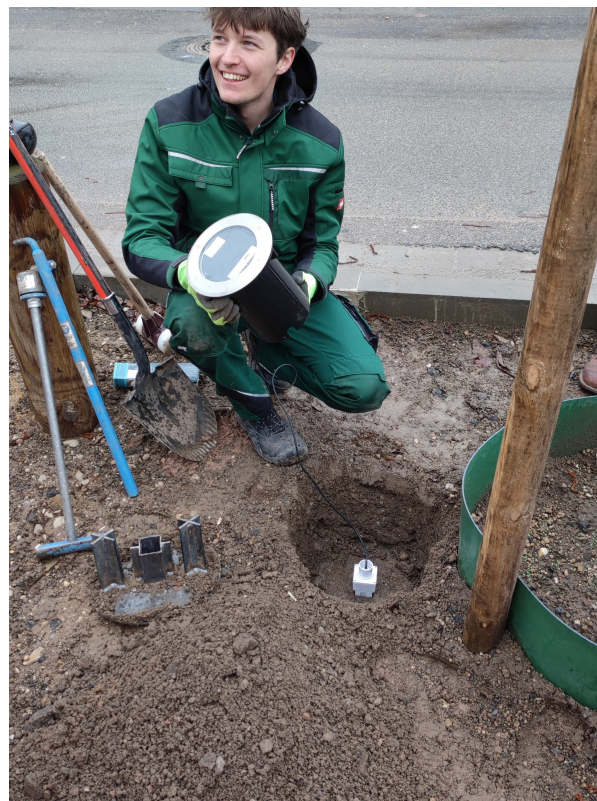
Bild 4: Eingeschlagener Climavi City Bodenfeuchtesensor in der Auswurzelungszone. Thomas Maier von der Firma Agvolution präsentiert die Übertragungseinheit.
