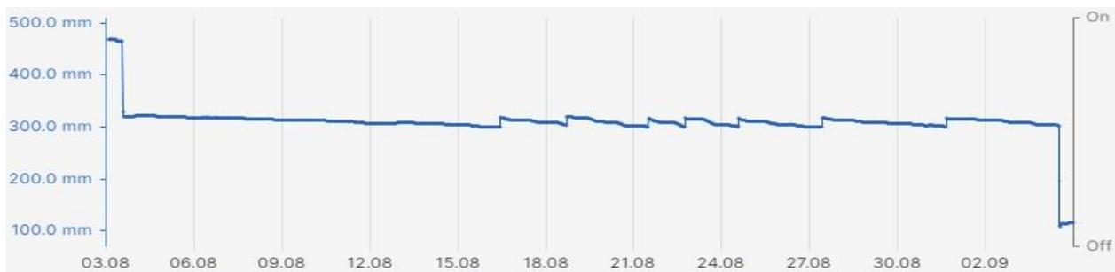
Abbildung 54 Lysimeter 05: Ergebnisse der Wasserbilanz im Zeitraum der kapillaren Steighöhe von 50 cm durch Pegelmessung eines im Wasserspeicher befindlichen Drucksensors in mm
