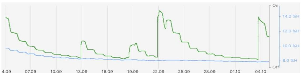
Abbildung 42 Lysimeter 06: Ergebnisse des volumetrischen Bodenwassergehalts im Zeitraum der kapillaren Steighöhe von 70 cm durch die Sensoren: Grün = "SMT 75 Bodenfeuchte 20cm [%]" Blau = "SMT 75 Bodenfeuchte 40cm [%]"
