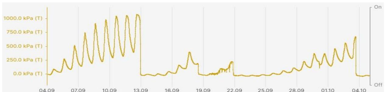
Abbildung 82 Lysimeter 03: Ergebnisse der Saugspannung im Zeitraum der kapillaren Steighöhe von 60 cm durch die Sensoren: Beige = "FRT 01 Tension 20cm [kPa]" Lila = "FRT 02 Tension 40cm [kPa]"
