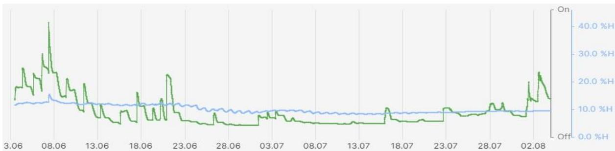
Abbildung 2 **Lysimeter 01**: Messergebnisse des volumetrischen Bodenwassergehalts in der Etablierungsphase durch die Sensoren: Grün = "SMT 75 Bodenfeuchte 20cm [%]" Blau = "SMT 75 Bodenfeuchte 40cm [%]"
