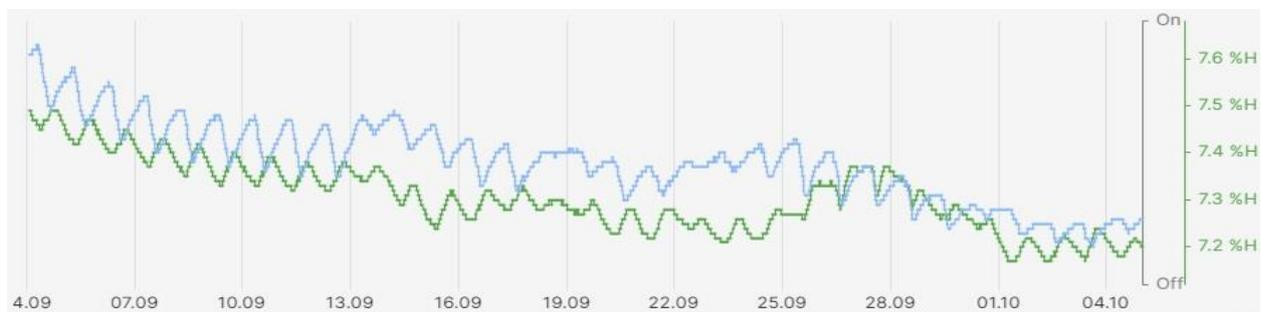
Abbildung 44 Lysimeter 04: Ergebnisse des volumetrischen Bodenwassergehalts im Zeitraum der kapillaren Steighöhe von 70 cm durch die Sensoren: Grün = "SMT 75 Bodenfeuchte 20cm [%]" Blau = "SMT 75 Bodenfeuchte 40cm [%]"
