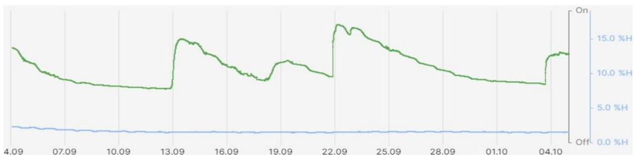
Abbildung 34 Lysimeter 03: Ergebnisse des volumetrischen Bodenwassergehalts im Zeitraum der kapillaren Steighöhe von 60 cm durch die Sensoren: Grün = "SMT 75 Bodenfeuchte 20cm [%]" Blau = "SMT 75 Bodenfeuchte 40cm [%]"
