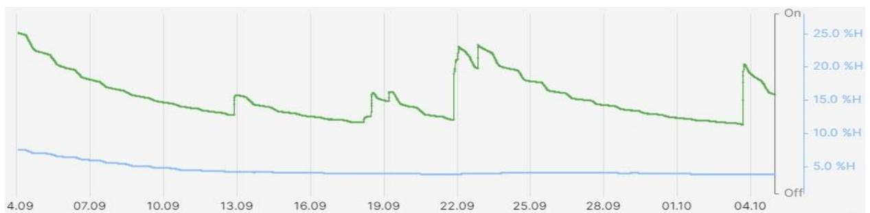
Abbildung 33 Lysimeter 02: Ergebnisse des volumetrischen Bodenwassergehalts im Zeitraum der kapillaren Steighöhe von 60 cm durch die Sensoren: Grün = "SMT 75 Bodenfeuchte 20cm [%]" Blau = "SMT 75 Bodenfeuchte 40cm [%]"
