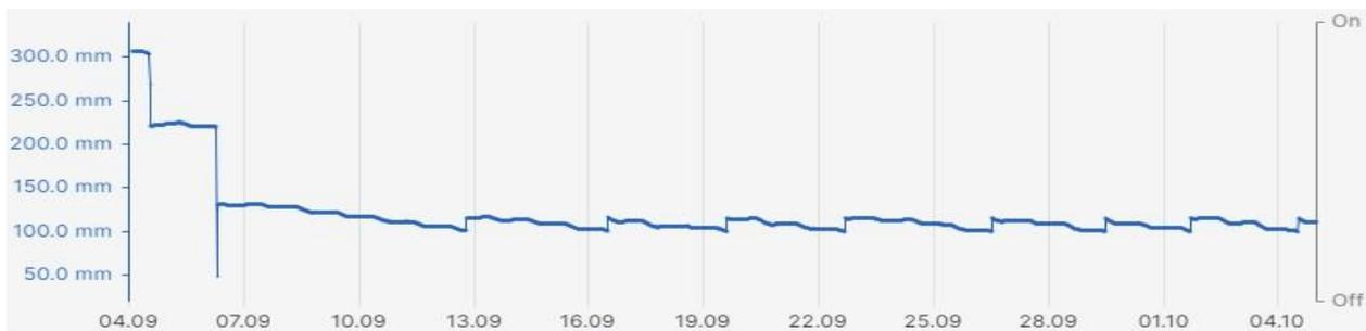
Abbildung 63 Lysimeter 06: Ergebnisse der Wasserbilanz im Zeitraum der kapillaren Steighöhe von 70 cm durch Pegelmessung eines im Wasserspeicher befindlichen Drucksensors in mm
