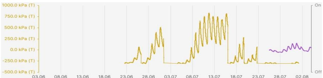
Abbildung 70 Lysimeter 06: Messergebnisse der Saugspannung in der Etablierungsphase durch die Sensoren: Beige = "FRT 01 Tension 20cm [kPa]" Lila = "FRT 02 Tension 40cm [kPa]"
