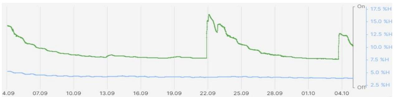
Abbildung 40 Lysimeter 04: Ergebnisse des volumetrischen Bodenwassergehalts im Zeitraum der kapillaren Steighöhe von 70 cm durch die Sensoren: Grün = "SMT 75 Bodenfeuchte 20cm [%]" Blau = "SMT 75 Bodenfeuchte 40cm [%]"
