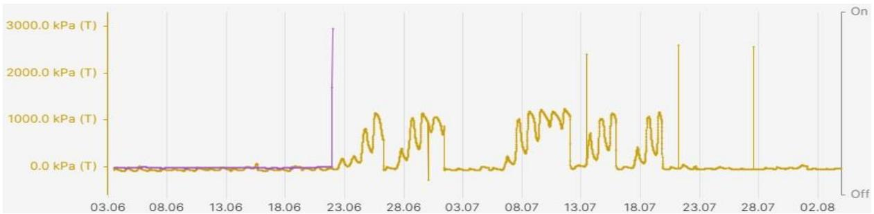
Abbildung 67 Lysimeter 03: Messergebnisse der Saugspannung in der Etablierungsphase durch die Sensoren: Beige = "FRT 01 Tension 20cm [kPa]" Lila = "FRT 02 Tension 40cm [kPa]"
