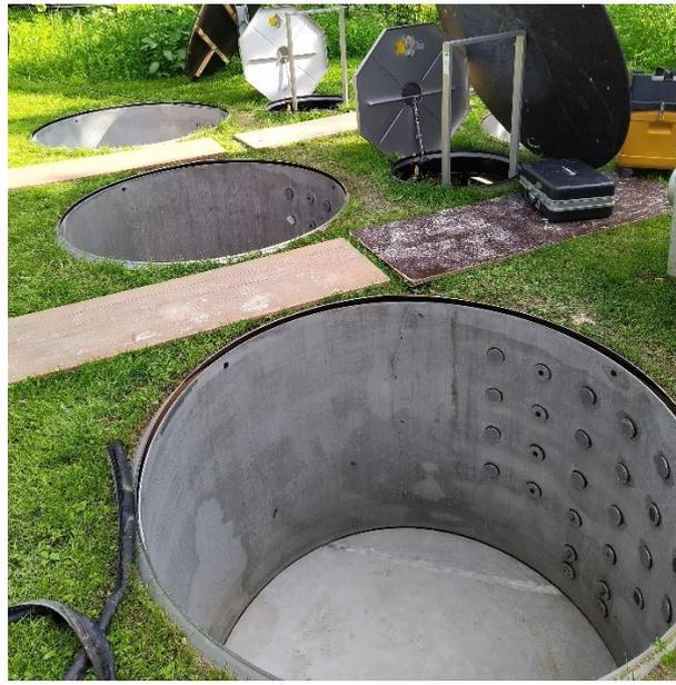
Bild 2: Leeres Lysimetergefäß mit Blick auf seitliche Sensordurchführungen. (Bildautor: ©Kendzia, LWG)
