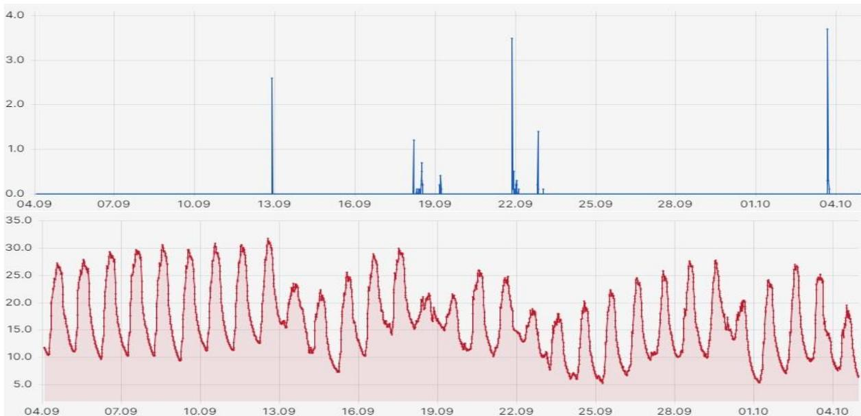
Abbildung 83 Wetterstation: Messergebnisse des Niederschlags in [mm] (oben) und der Temperatur in [degC] (unten) im Zeitraum der kapillaren Steighöhe von 70 cm
