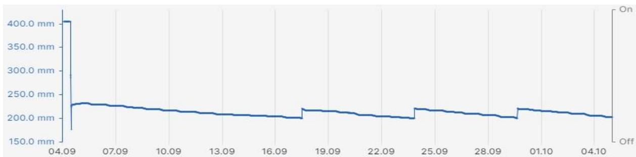
Abbildung 57 Lysimeter 01: Ergebnisse der Wasserbilanz im Zeitraum der kapillaren Steighöhe von 60 cm durch Pegelmessung eines im Wasserspeicher befindlichen Drucksensors in mm
