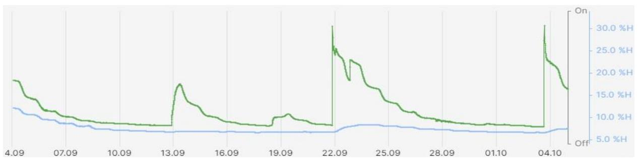
Abbildung 41 Lysimeter 05: Ergebnisse des volumetrischen Bodenwassergehalts im Zeitraum der kapillaren Steighöhe von 70 cm durch die Sensoren: Grün = "SMT 75 Bodenfeuchte 20cm [%]" Blau = "SMT 75 Bodenfeuchte 40cm [%]"
