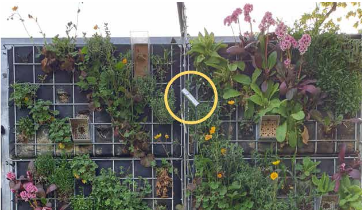
Bild 14: Temperatursensor vor der begrünten Gabione an der KFS, Westfassade.
