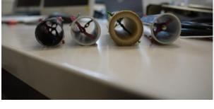
Abbildung 128: Seitenansicht, Befestigung mit Isolierdraht
