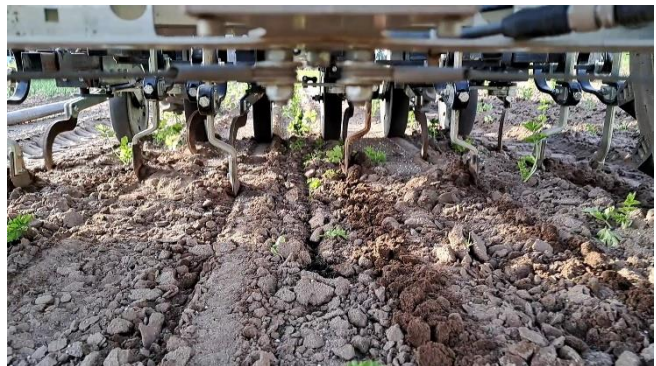
Bild 3: Autonomer Hackgang des „Farming GT“ auf einem Praxisbetrieb in Sellerie. Jeweils zwei bewegliche Hockeymesser arbeiteten von links und von rechts in eine Reihe hinein. Zudem hackten Gänsefußscharen und Winkelmesser den Bereich zwischen den Reihen sowie die Spur.
