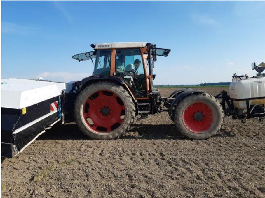
Bild 19: Die ARA-Pflanzenschutzspritze im Einsatz auf der Kohlversuchsfläche. Die Kulturpflanzen waren im Keimlingsstadium und es war fast nur blanker Boden zu sehen. In diesem Stadium besteht große Gefahr durch Totalschäden durch Kohlerdföhe und es wird sehr häufig flächig behandelt
