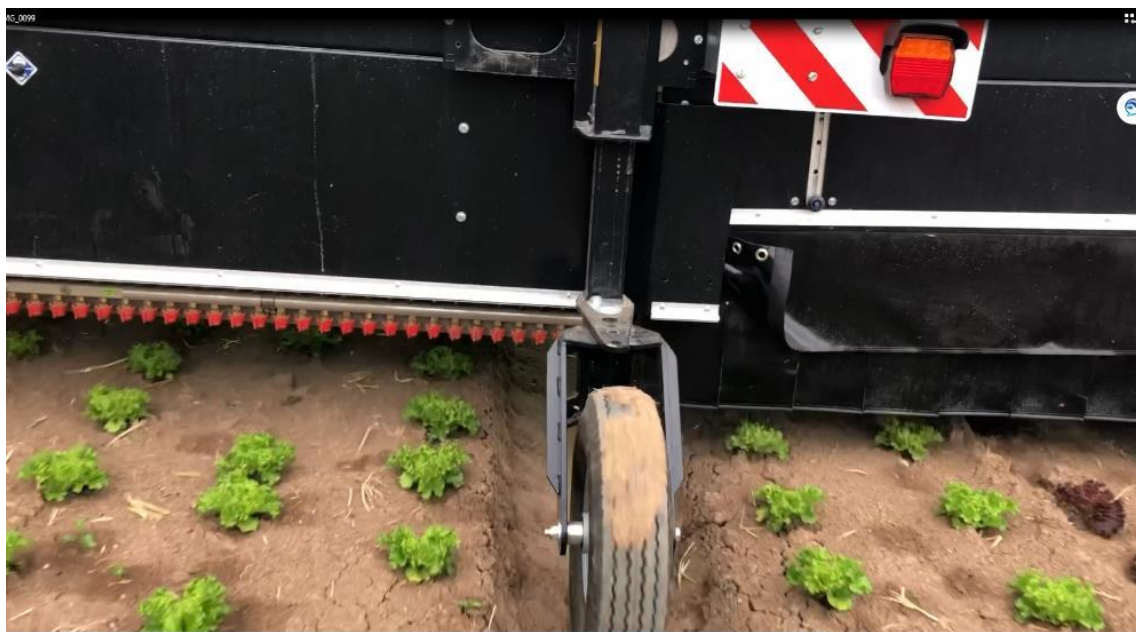
Abbildung 51: Unkrautbehandlung ohne Schutzzone bei grünem Lollo Salat, dunkle Flecken weisen auf erkanntes und benetztes Unkraut hin
