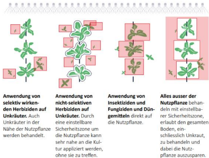
Abbildung 3: Applikationsmöglichkeiten mit der ARA-Pflanzenschutzspritze (Produktdatenblatt ARA-Pflanzenschutzspritze, Ecorobotix, 2023)
