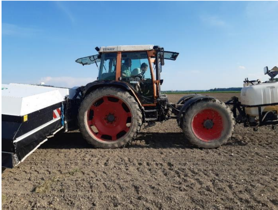
Abbildung 22: Die ARA-Pflanzenschutzspritze im Einsatz auf der Kohlversuchsfläche. Die Kulturpflanzen waren im Keimlingsstadium und es war fast nur blanker Boden zu sehen. In diesem Stadium besteht große Gefahr durch Totalschäden durch Kohlerdföhe und es wird sehr häufig flächig behandelt
