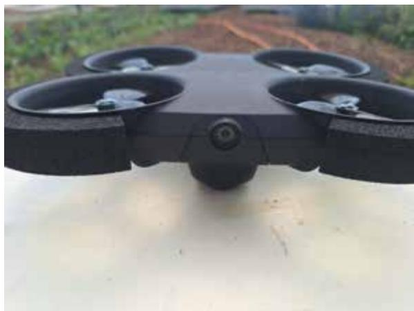
Bild 5: Hochauflösende Hi-Res-Kamera zur Markierungserkennung
