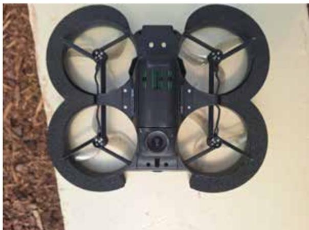
Bild 4: RGB-Kamera bildet das menschliche Sehvermögen nach zur Bestandsorientierung
