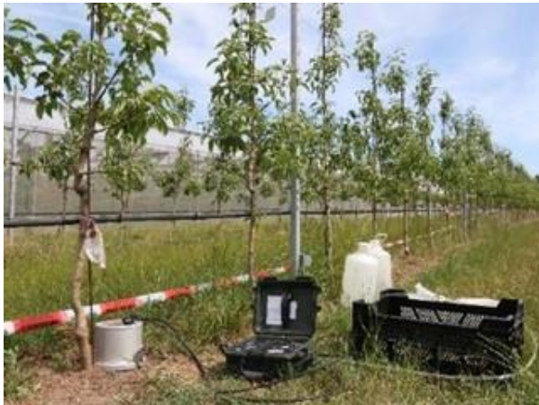
Abbildung 15: Aufbau des Dual-Head-Infiltrometers
