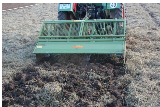
2 x Spatenmaschine zur Einarbeitung der Kleegrassilage
