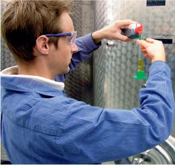
Schutzbrille nicht vergessen: Ob beim Bestimmen der Gesamtsäure in einer Probe von Wein im Keller (links) oder im Labor (rechts) – weil dabei Lauge zum Einsatz kommt, ist Schutz der Augen sehr zu empfehlen
