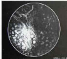
4. Leuchtfeldblende mit der Höhenverstellung des Kondensators scharf stellen
