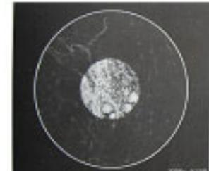
6. Leuchtfeldblende öffnen, bis sie ringsherum gleichmäßig aus dem Sehfeld verschwindet
