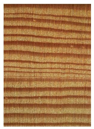
Abbildung 3: Lärche, Querschnitt; Lupenbild im Maßstab 6:1 (Foto: R. Rosin, D. Grosser)
