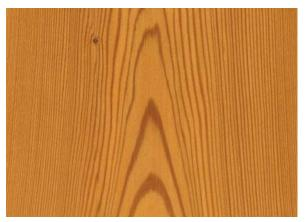
Abbildung 2: Holz der Lärche (Fladerschnitt) (Foto: R. Rosin, D. Grosser)
