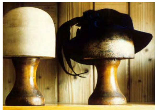
Abbildung 11: So genannte »Holzköpfe« in der Hutmacherei; Reißzwecken und Stecknadeln lassen sich leicht eindrücken. Foto: W. Teetz
