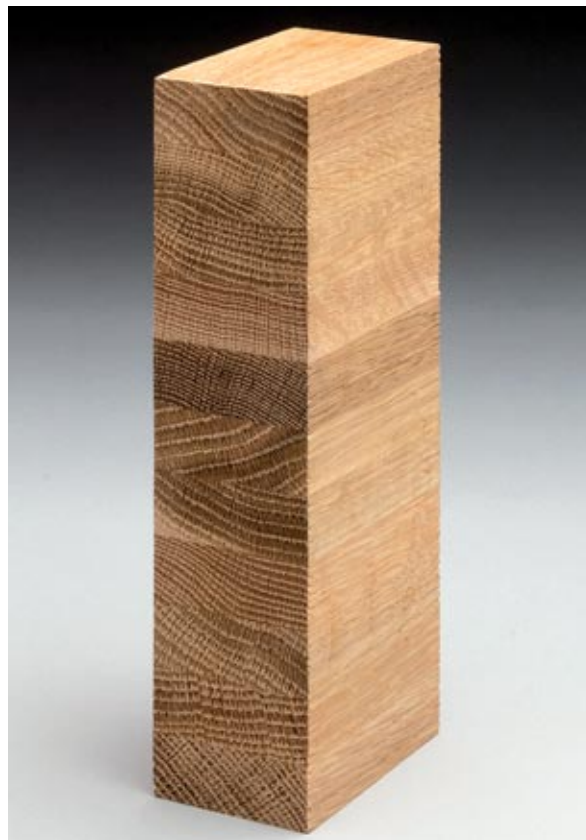
Abbildung 15: Modell Eichenbrettschichtholz. Foto: Holzforschung München
