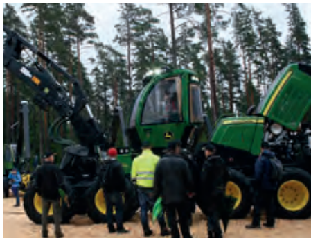
2 8-Rad-Harvester sind im Kommen, u.a. wegen den Anforderungen bezüglich des Bodenschutzes. Links der 1170G von John Deere, rechts der 931 XC von Komatsu; Fotos: M. Wolf
