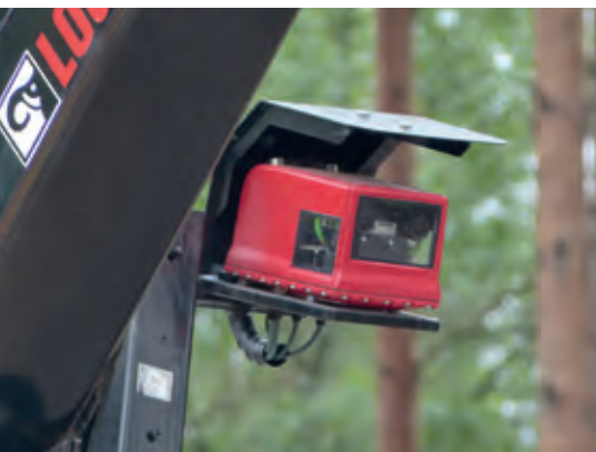
3 Das Kamerasystem HiVision von HIAB ersetzt zusammen mit einer VR-Brille den Steuerstand am Kran. Die Bedienung des Krans ist aus dem Führerhaus des LKWs möglich. Foto: M. Wolf
