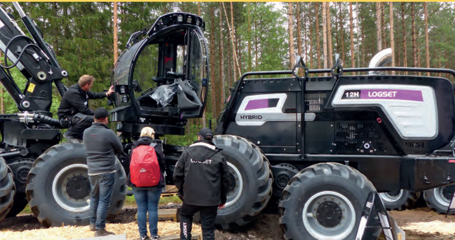
1 Logset 12 H GTE hybrid: der erste serienmäßige Hybrid-Harvester.
