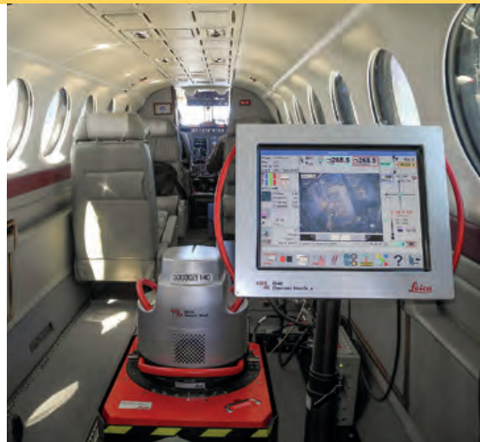
1 Hochwertige, digitalen Großformat-Kameras, eingebaut in Flugzeugen, ermöglichen den Fernerkundungsspezialisten neue Wege der Baumartenidentifizierung. Foto: ©VBS
