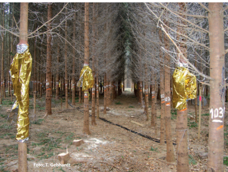
Abbildung 1: Mit Sensoren zur Saftstrommessung ausgestattete Bäume auf der konventionell durchforsteten Fläche
