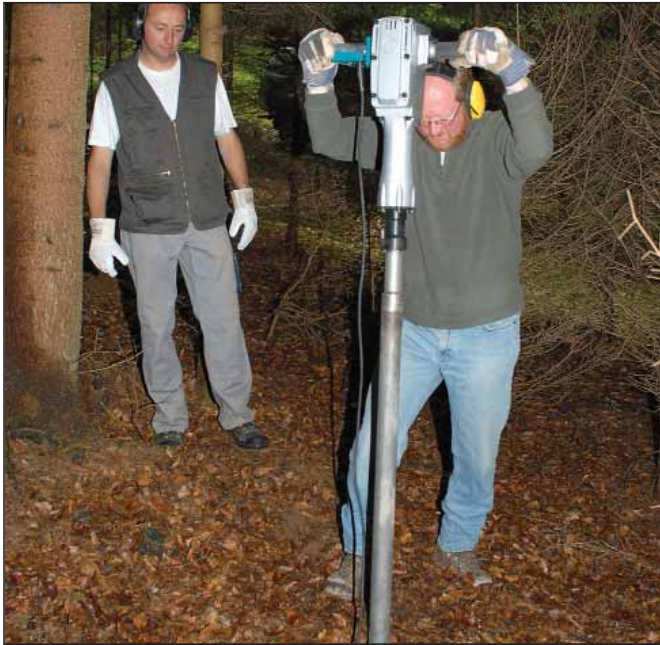
Abb. 2: Mit einem Spezialbohrer (Rammkernsonde und Elektrohammer) gewinnt Alfred Schubert, Mitarbeiter an der LWF (rechts im Bild), die Bodenproben aus bis zu 1,5 m Tiefe. (Foto: T. Bosch)
