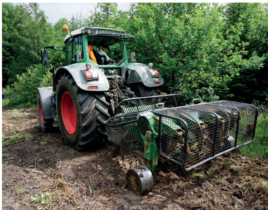
4 Aufbruchlockerer OWR MM 100 bei der Lockerung einer verdichteten Rückegasse Foto: S. Waas, LWF
