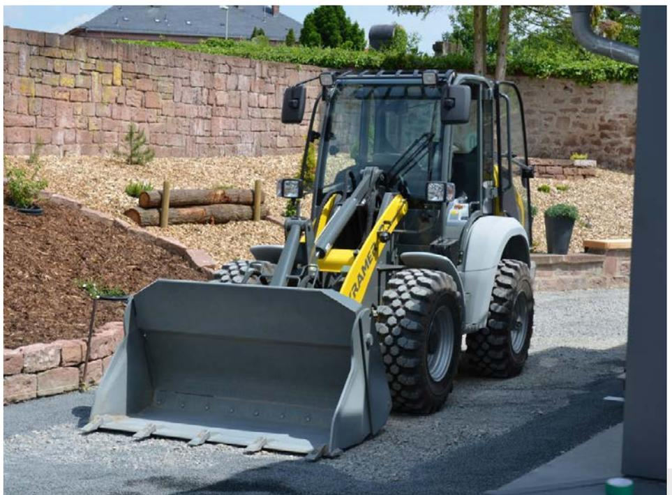
Bild 1: Eine Seltenheit im Fuhrpark der GaLaBau-Unternehmen: Ein vollelektrisch angetriebener Radlader.
