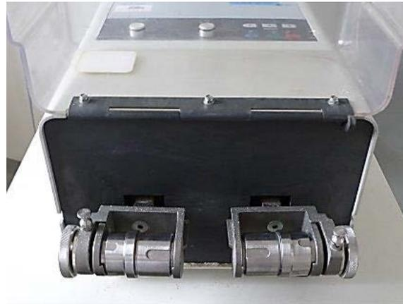
Abb.37: Kugelmühle mit eingespannten Mahlbechern
