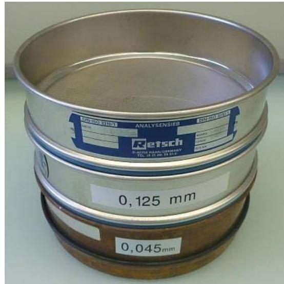
Abb. 31: Siebkombination mit drei unterschiedlichen Maschenweiten
